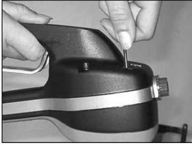
obr. 3 Umístění tlačítka ENTER v dutině na spodní části krytu měřiče - ke stisknutí použít kulatinu \varnothing 2 mm.
